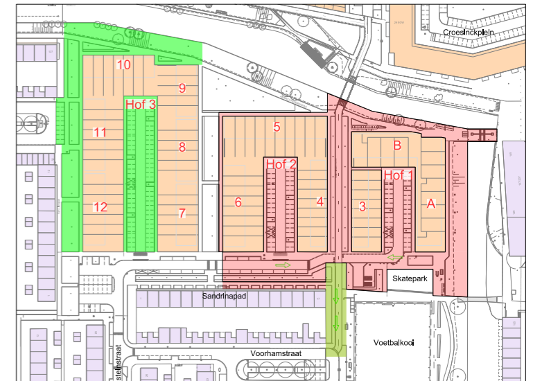
Stap 4: Bestrating Hof 3, voetpad rondom blok 10 t/m 12 parkeervakken Bootsmastraat Tijdspad: april 2023 t/m mei 2023
