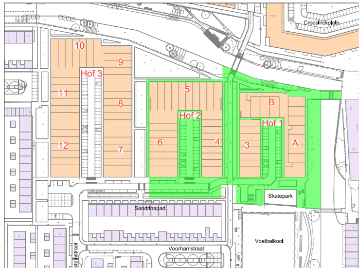
Stap 1: Bestrating Hof 1 en 2, voetpad rondom blok A, B, 2 t/m 6 bestrating rijbaan ontsluiting, bestrating afvalinzameling locatie Tijdspad: februari t/m april 2023
